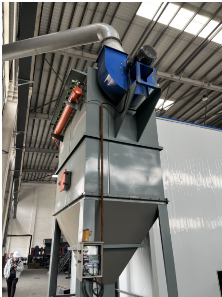
图3-1 破碎废气处理装置
