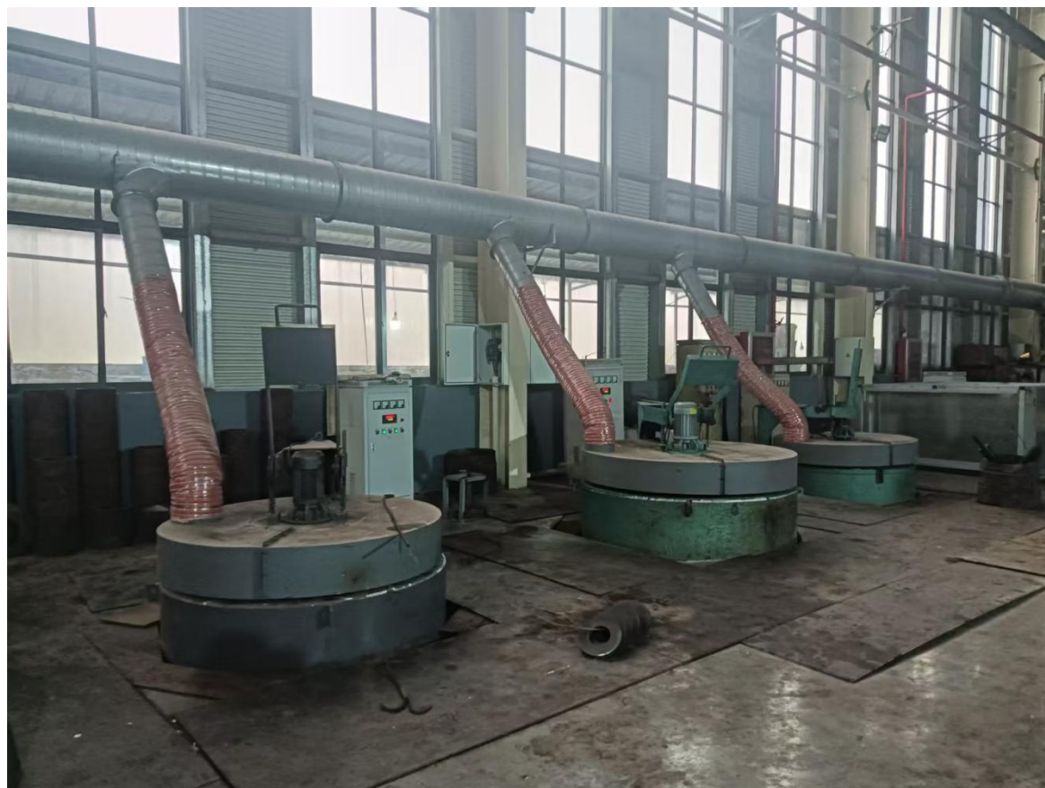
图3-4 热处理工序风管密闭收集
